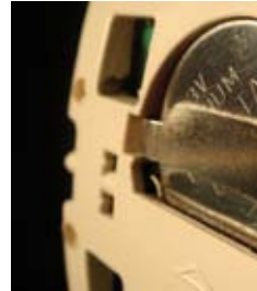
Pila de litio de 3 V incorporada de 10 años de duración.
