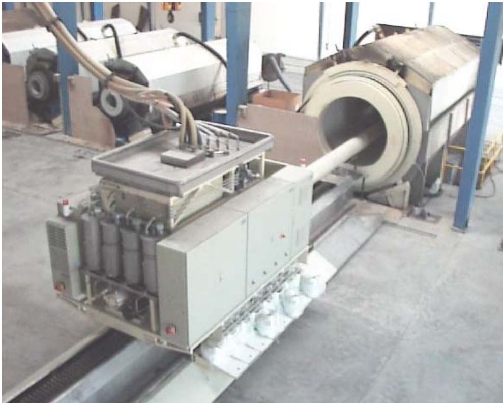
Fig. 1 Proceso de alimentación: En primer plano el alimentador con su brazo en el interior del molde.
