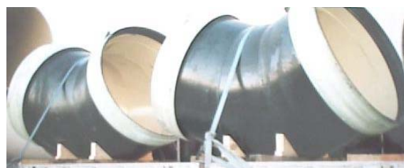
Fig. 6 Piezas especiales realizadas en poliéster reforzado con fibra de vidrio.
