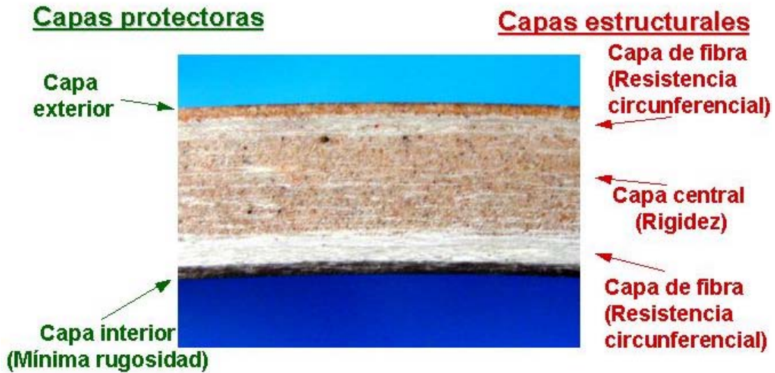
Fig. 5 Todos los espesores de la capa se diseñan específicamente tanto en su espesor como en su composición, para adaptarse a las exigencias y requisitos del proyecto.
