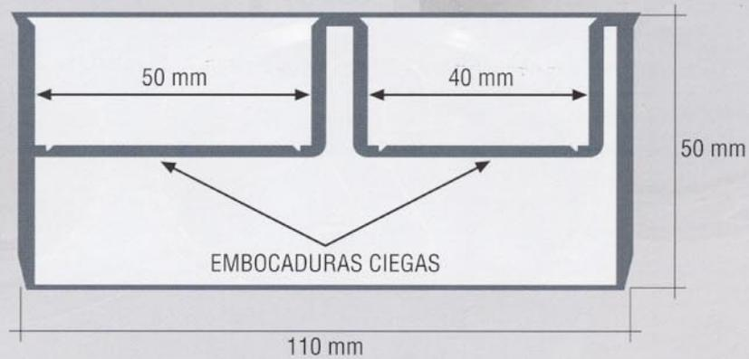
Tapón Ø110 macho con entradas ciegas de Ø50 y Ø40 mm hembra.
