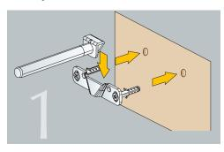
FIJAR EL SOPORTE A LA PARED CON LOS TACOS Y TIRAFONDOS SUMINISTRADOS Y COLOCAR EL VÁSTAGO SOBRE EL SOPORTE.
