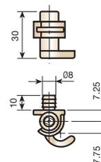
LEVA LARGA IZQUIERDA CON ABRAZADERA M/PRESIÓN Ø 8.
