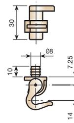
LEVA LARGA DERECHA CON ABRAZADERA M/PRESIÓN Ø 8.
