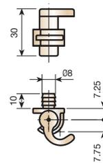
LEVA CORTA DERECHA CON ABRAZADERA M/PRESIÓN Ø 8.
