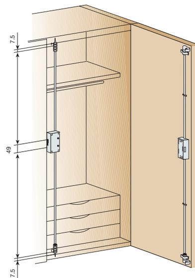
PARA PEDIR CORRECTAMENTE LAS VARILLAS DE FALLEBA, SE DEBE TENER EN CUENTA LA MEDIDA INTERIOR DEL ARMARIO, DESCONTAR 64 MM. Y SE OBTIENE LA SUMA DE LAS DOS VARILLAS. PARA DELIMITAR LA MEDIDA DE CADA UNA DE LAS VARILLAS, DEBERÁ SER EL CLIENTE EL QUE LA INDIQUE, EN FUNCIÓN DE LA ALTURA A QUE DESEE INSTALAR LA CERRADURA.
