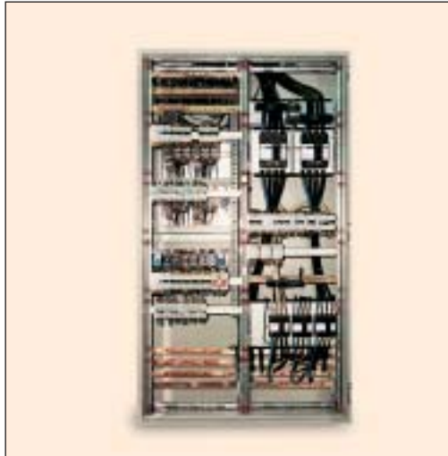
Detalle vista interior instalación armario CMD con chasis equipado con carriles regulables para fijación aparellaje modular DIN, placas de montaje parciales y soportes de barras horizontales.
