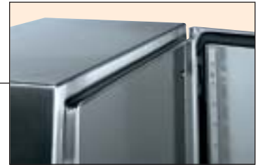
Junta de poliuretano y perfil en forma de canal para asegurar una total estanqueidad (IP66).
