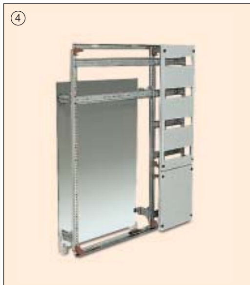
La fijación como "placa parcial" al chasis en armarios CMD se realiza mediante soportes SDCD . En este caso deberán cambiarse las patas estándar por otras más altas SPP/CMD . Ambos conjuntos SDCD y SPP/CMD deberán pedirse aparte.
