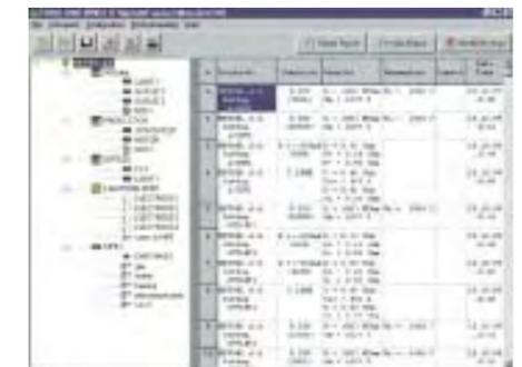
La versión de software "Eurolink Pro" permite diseñar y crear estructuras de instalaciones, programando mediciones en cada punto. La estructura se transmite al Eurotest, para volver a recuperarla con valores y realizar informes altamente profesionales.
