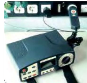
Identificación de circuitos en el cuadro, mediante el localizador KMA 1005.
