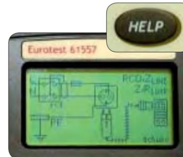
Botón "Ayuda", que nos muestra el esquema de conexión para cualquier medición.
