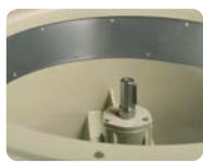
Banda de aluminio para prevenir chispas según norma EN-14986:2006
