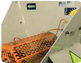
Engrasadores externos para facilitar el mantenimiento
