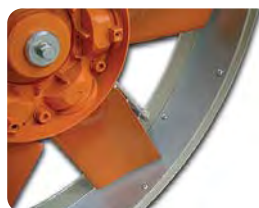
THT/ATEX: Banda de aluminio para prevenir chispas según norma EN-14986:2006
