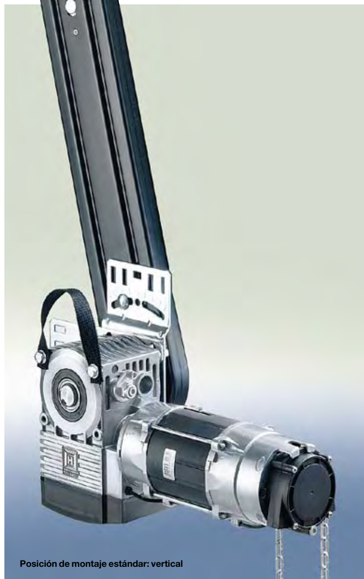
Automatismo de eje WA 400 con transmisión por cadena y cadena manual de emergencia (manejable desde el suelo)
