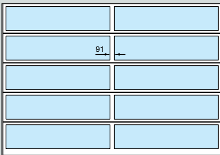
Modelos mayores de 3330 mm de ancho con perfil vertical (91 mm)
