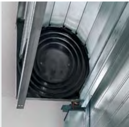
Guía de paneles sin contacto en la consola espiral.
