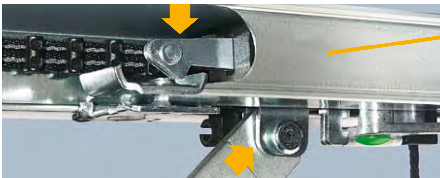
El bloqueo de la puerta en la guía del automatismo – patente de Hörmann
