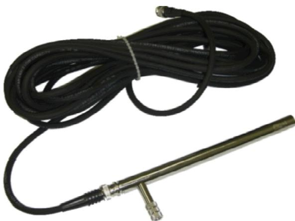
El **MX025** es un conjunto de preamplificador alimentado con corriente constante ICP® **PA-25** + micrófono prepolarizado **C-250**.
