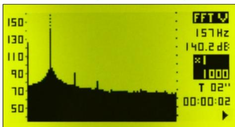
El módulo de medición de vibraciones del sonómetro **SC310** incorpora 2 modos de medición; modo de medición de la exposición humana de cuerpo entero a las vibraciones en edificios y modo para el análisis frecuencial de banda estrecha FFT (Fast Fourier Transform) de vibraciones.
