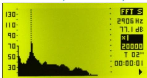
Este módulo de análisis frecuencial extendido del sonómetro **SC310** incorpora 2 modos de medición: modo análisis frecuencial extendido en 1/3 de octava y modo análisis frecuencial de banda estrecha FFT (Fast Fourier Transform).
