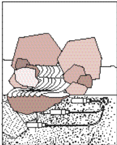
Muestreador Remoto de Agua Subterránea, 1911 Instalado
