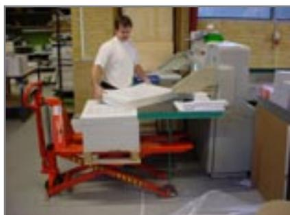
Se pueden transportar y elevar 1.500 kg hasta 400 mm de altura. A partir de 400 mm la capacidad se reduce a 1000 kg.
