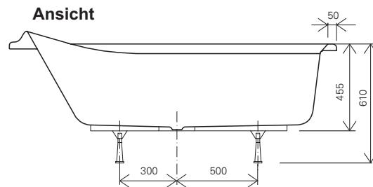
14. Markieren Sie auf den Wandfliesen die tatsächliche Höhe des oberen Wannenrandes. Sie muss sich in einer Höhe von  $610 \pm 5$  mm über der Ebene des Fußbodens befinden (Abbildung 2).
