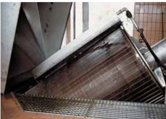
Tamiz ROTAMAT® Ro 2, colocado directamente en el canal, con cubierta, completamente en acero inoxidable
