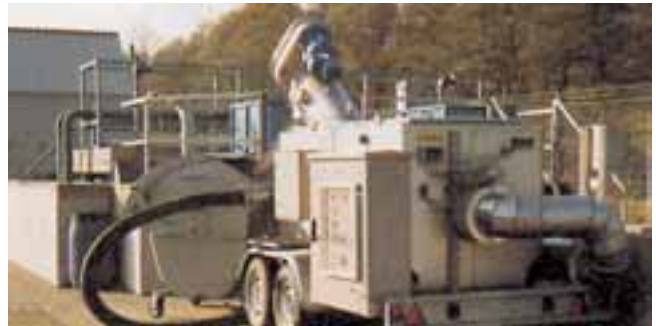
Versión móvil de una Planta de Tamizado de Fangos
