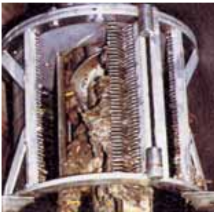
El material flotante es retenido dentro de la cesta, las púas pasan a través de la cesta y aseguran de forma automática una limpieza completa.
