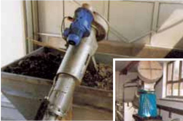
Los residuos deshidratados son descargados a un contenedor o una bolsa
