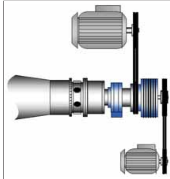
Sistema "Back-drive" con motor principal para el accionamiento del tambor y motor de freno con reductor para la de velocidad de giro diferencial; control mediante dos variadores de frecuencia
