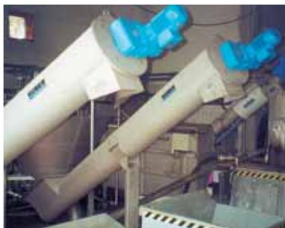
**Planta de lavado de arenas COANDA, con tamizado previo:**
