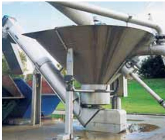
*Tecnología innovadora: Planta de lavado de arenas COANDA RoSF 4/tamaño III, versión con calefacción para el funcionamiento al aire libre.*
