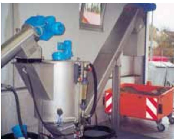
**Planta de lavado de arenas RoSF 4/t para arena parcialmente deshidratada:**
