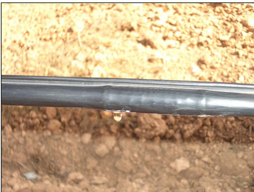
Sistema de tubería, alambre y gotero integrados en un mismo producto
