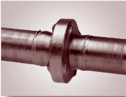
**Manguito termorretráctil utilizado para el sellado impermeable entre la tubería y la unión por brida.**
