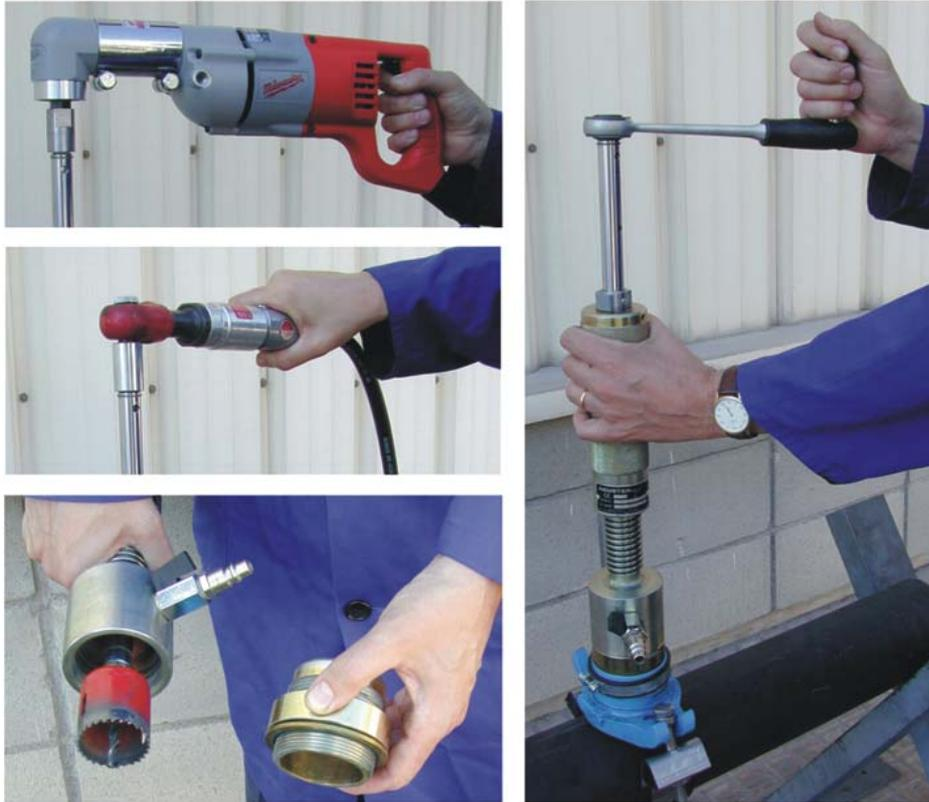
La máquina de perforar tuberías, con o sin carga, modelo **AcuDrill**, está especialmente diseñada para ser utilizada sobre collarines o accesorios con salida roscada.
