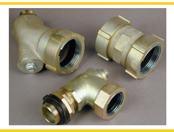
La gama de accesorios de fundición nodular está compuesta de *tes de toma en carga y manguitos*. Las tes se utilizan para efectuar ramales en carga directamente sobre tuberías de fundición gris o dúctil, o bien sobre cualquier tipo de tubería a la que previamente se haya instalado una abrazadera o collarín con salida roscada.
