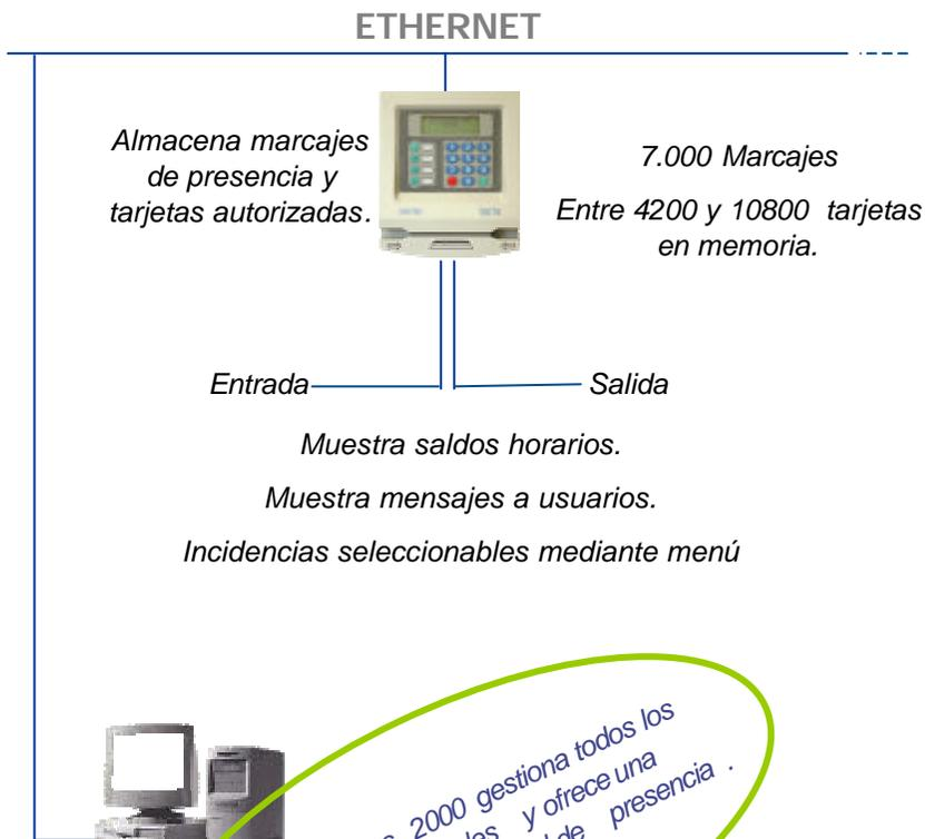
El software Evalos 2000 gestiona todos los datos de los terminales y ofrece una información precisa del control de presencia.
