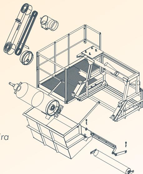
Cabeza de cinta transportadora en bastidor de celosía de angular
