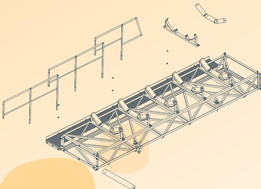
Tramo intermedio de cinta transportadora en bastidor de celosía de angular
