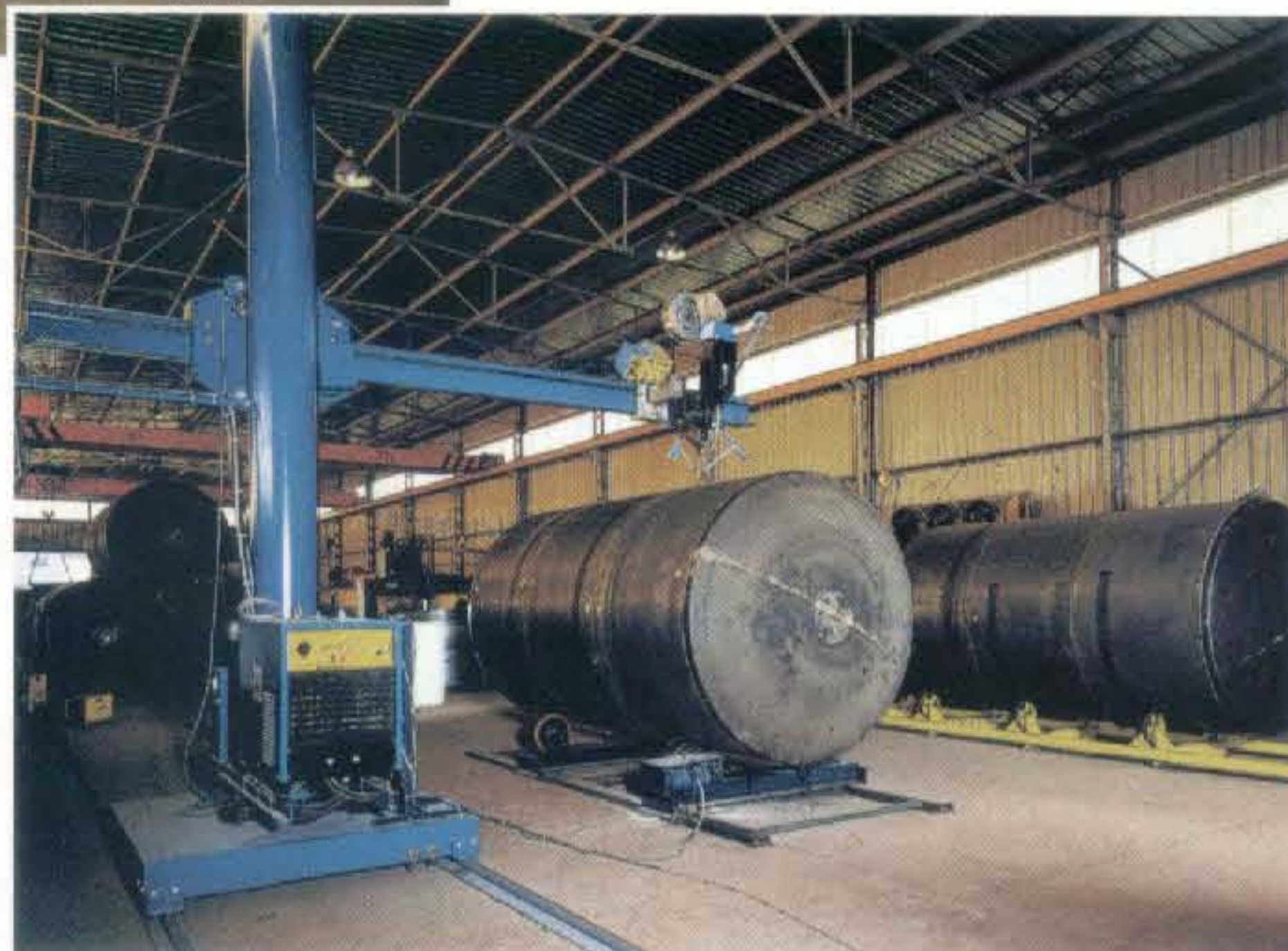
BANCO DE SOLDADURAS-COLUMNNA ARCO SUMERGIDO
