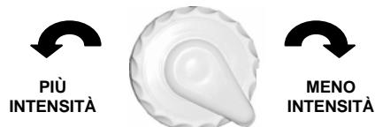
I jet possono regolare l'intensità della portata quando si apre o si chiude l'acqua. Procedere come indicato di seguito:
