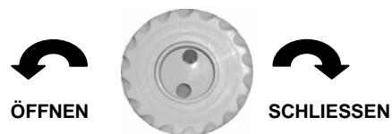
Durch eine Vierteldrehung des Außenrings im Gegenuhrzeigersinn werden die Jets geöffnet.
