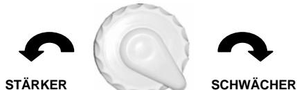
Mit den Jets kann man auch die Durchflussmenge durch das Öffnen und Schließen des Wasserdurchlaufs regulieren. Gehen Sie wie folgt vor:
