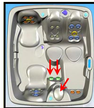
Successivamente, passa attraverso lo scambiatore di calore e quando ne esce riceve l'iniezione di ozono. L'acqua si distribuisce attraverso tutti i jets in funzione della posizione della valvola di regolazione del getto (Vedere 5.5) Parte del getto d'acqua, si distribuisce anche attraverso il canale di scolo per evitare che si formino ristagni d'acqua.
