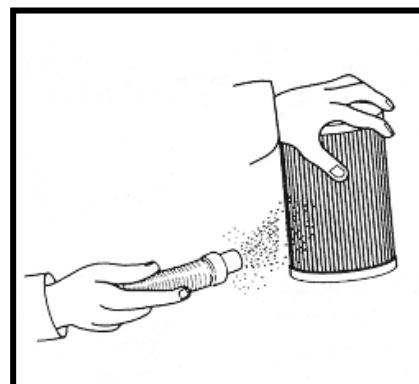
5. Tras varios ciclos de lavado puede ser necesario el cambiar el cartucho filtrante.
