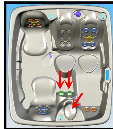
Seguidamente, pasa por el intercambiador de calor y en la salida de éste se le inyecta el ozono. El agua se distribuye por todos los jets en función de la posición de la válvula de caudal. (Ver 5.5) Y parte de este caudal, también se distribuye a través del desagüe para evitar que pudiese quedar agua estancada.
