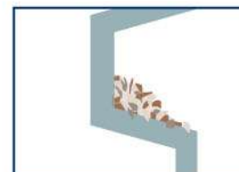
Acumulación de sólidos en los huecos interiores de los equipos de pared simple.
