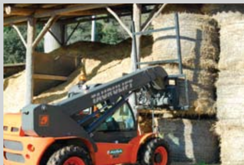
Horquillas con desplazador lateral con sistema Multi-Tach de cambio rápido
