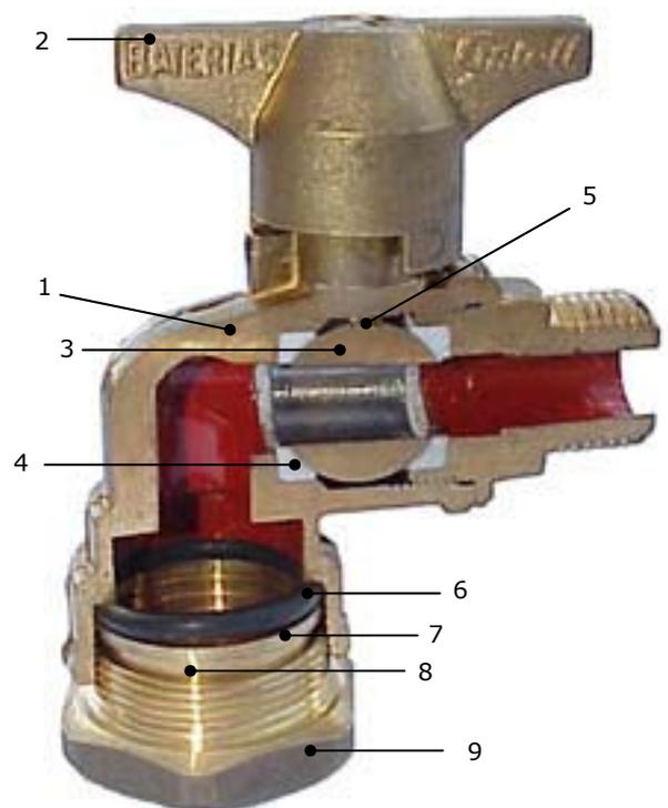
Esta válvula cumple con la norma UNE 19804 vigente y con las Normas Básicas para las Instalaciones Interiores de Suministro de Agua del Ministerio de Industria publicadas en el B.O.E. el 13/01/76, apartado 1.4.1.: "Los materiales empleados en tuberías y grifería deben ser capaces, de forma general y como mínimo, para una presión de trabajo de 15 kg/cm<sup>2</sup>".
