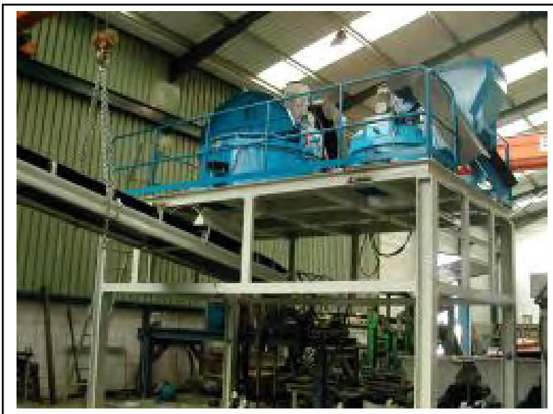
Mezcladora vibrocompresora + mezcladora doble capa + soporte mezcladora Preiss Mixer + Double Layer mixer + Mixer support
