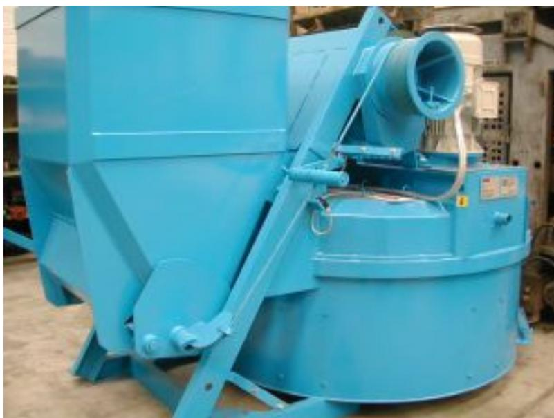
SKIP DE CARGA: De forma tronco-piramidal para el buen deslizamiento del material. Sirve para trasvasar los áridos al interior de la cuba de mazclado mediante un fondo con bisagras que evita la salida del polvo.
