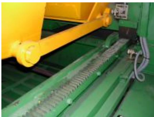
Llenado del molde, por sistema de parrilla vaivén, guiada por 4 ruedas, por medio de motoreductor con doble salida y dos bielass de movimiento vertical y eje compensador.
