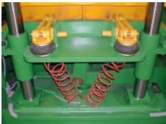
Ajuste de **la presión del contramolde**, memorizada por cada molde, y progresiva (PPS )
