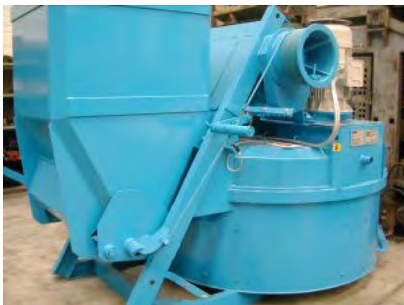
EL REDUCTOR DE LA MEZCLADORA: Con planetario situado en la parte duperior, dejando libre y útil toda la cuba.
