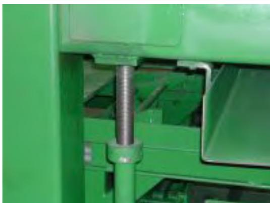
Fácil elevación de la máquina, para adaptarse a la altura del molde, por medio de 6 tornillos de fácil acceso, y cuatro cilindros hidráulicos, con motobomba, para efectuar una elevación rápida y equilibrada.
