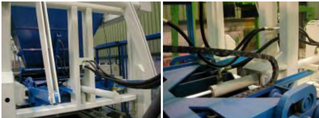
Cajón alimentador, guiado lateralmente por medio de 4 ruedas verticales, con dobles bielas, eje compensador, y un cilindro hidráulico. Control del llenado por sonda.
