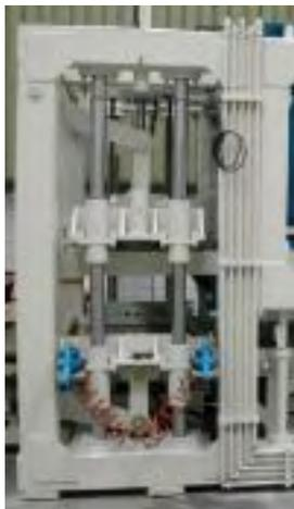
El molde y contramolde, vienen guiados por 4 columnas cromadas, de diámetro 80 mm, con rascadores, bielas, manivela y eje compensador de gran diámetro.
