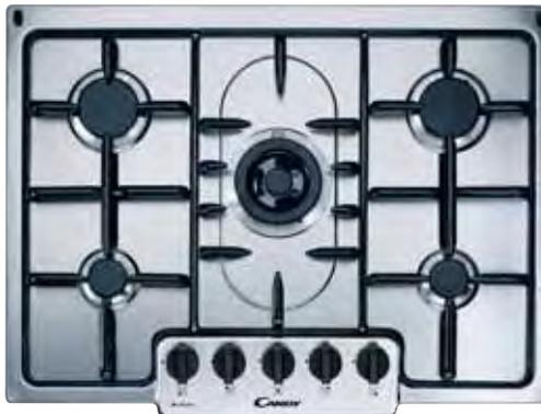
Ancho **75 cm** > **Acero inoxidable** > 5 quemadores a gas: 2 quemadores ultra rápidos 2.65 kW, 2 quemadores semi-rápidos 1.5 kW, 1 quemador de doble corona 3.3 kW > **3 rejillas esmaltadas** > Encendido electrónico integrado > Encimera de una sola pieza > **Válvula de seguridad Sicurflame** > Potencia total: 11,6 kW > Tapa de cristal templado opcional: CR PG 75 X
