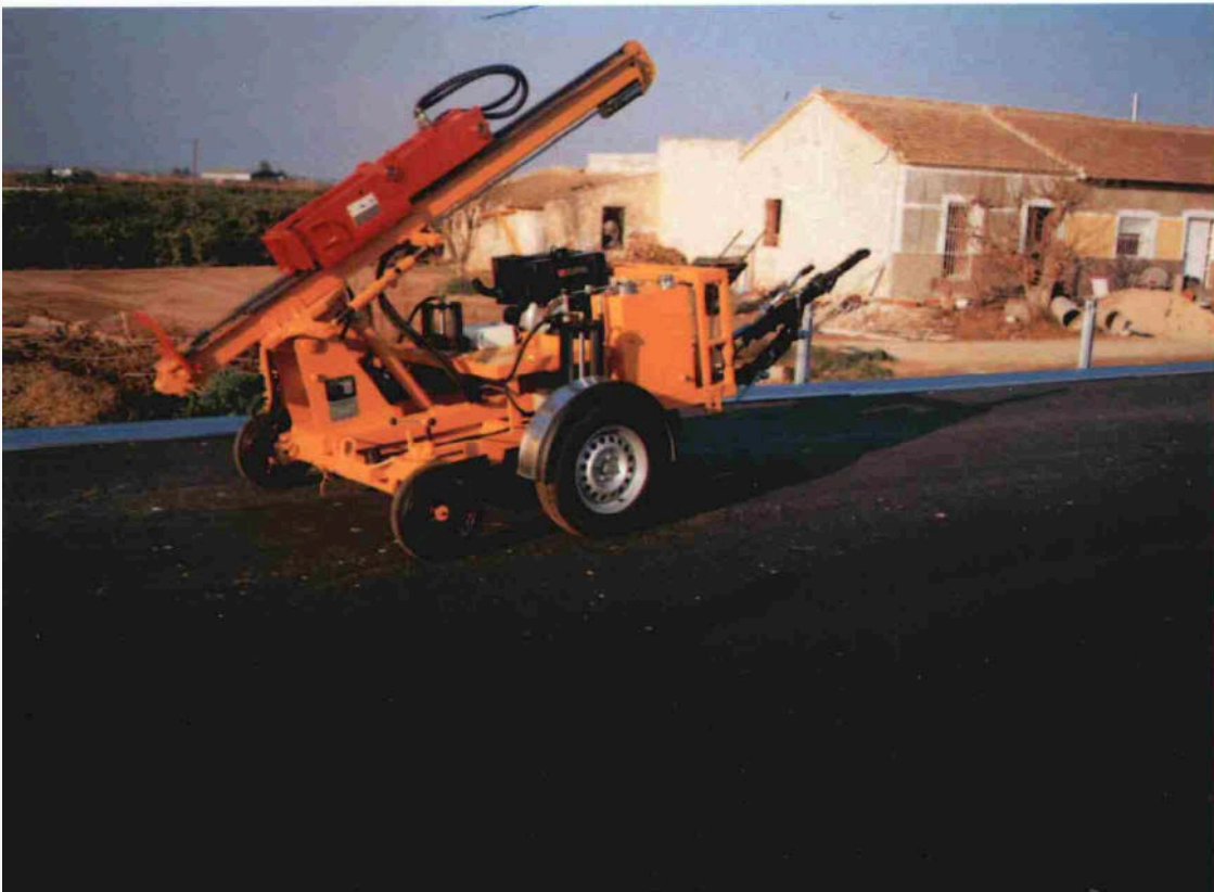
Modelo 3 MHP-250 en posición de traslado con barra articulada. Model 3 MHP-250 in translation position with articulated bar.
