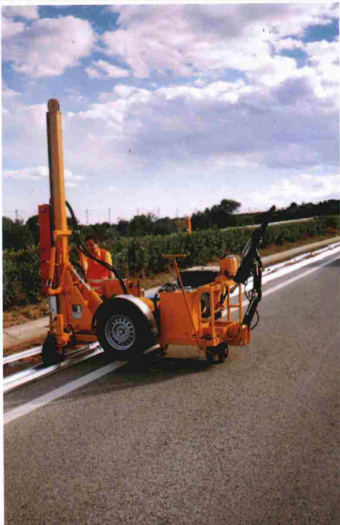
Modelo 4 MHP-250 en posición de trabajo con frenos automáticos, y barra articulada. Model 4 MHP-250 in working position with automatic brakes, and articulated bar.
