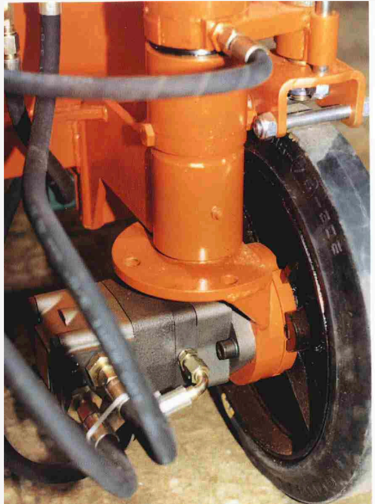
Detalle de tracción y frenos automáticos hidráulicos. Close view of traction and automatic hydraulic brakes.
