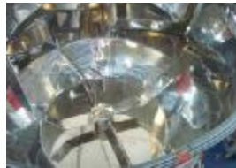
Detalle interior mezclador WSQB y aspas mezcladoras
