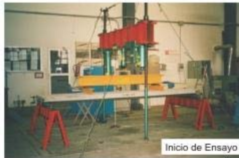
Ensayo de Losa de longitud entre apoyos de 3,60 m.
