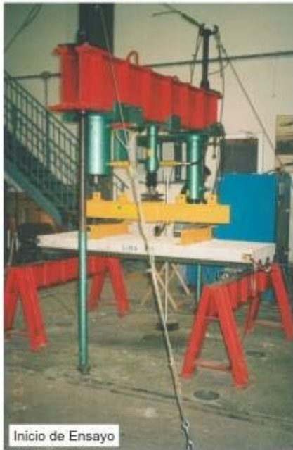
Ensayo de Losa de longitud entre apoyos de 1,80 m.
