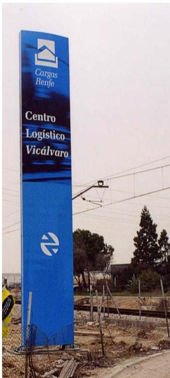
Monolito de ubicación con rotulación a doble cara de base rectangular con estructura interior y placas de asiento en acero galvanizado en caliente.
