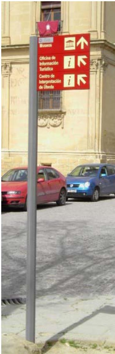
Panel con rotulación a una cara, de dimensiones variables , realizado mediante perfil perimetral de 35 mm en perfilería de aluminio extrusionado.
