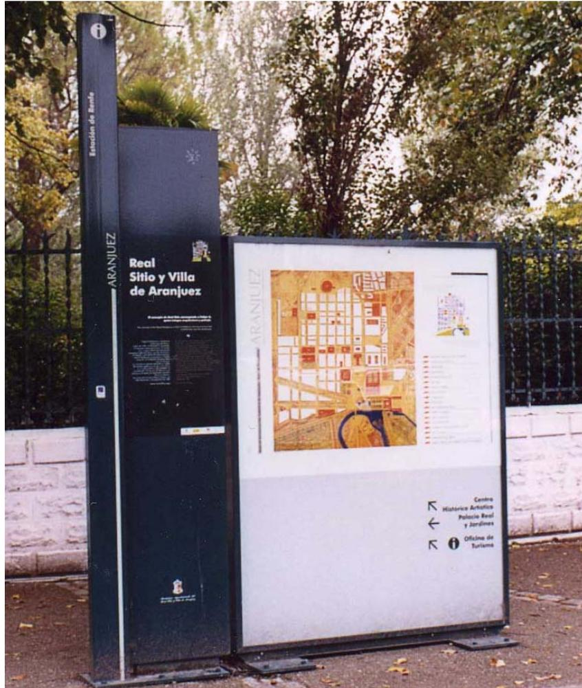
Conjunto de paneles informativos con rotulación a doble cara, compuesta de poste y panel. Poste en perfil de acero galvanizado.
