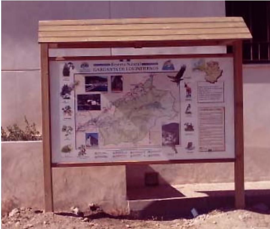
Panel informativo, con rotulación a una o dos caras, compuesto de panel central con tejadillo y postes, todo realizado en madera tratada en autoclave.
