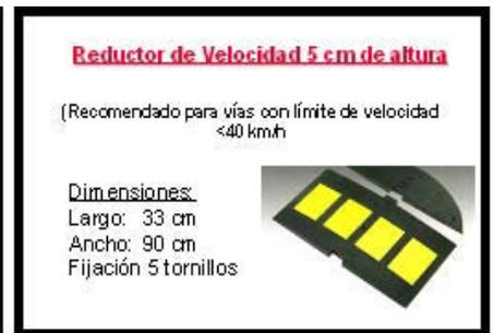
La instalación se realiza mediante tacos de expansión que permite un perfecto anclaje al suelo. Ha de evitarse cualquier tipo de adhesivo en combinación o sustitución del taco de expansión, ya que no permitirían ni el flujo de las aguas por debajo ni la fácil retirada de los componentes.
