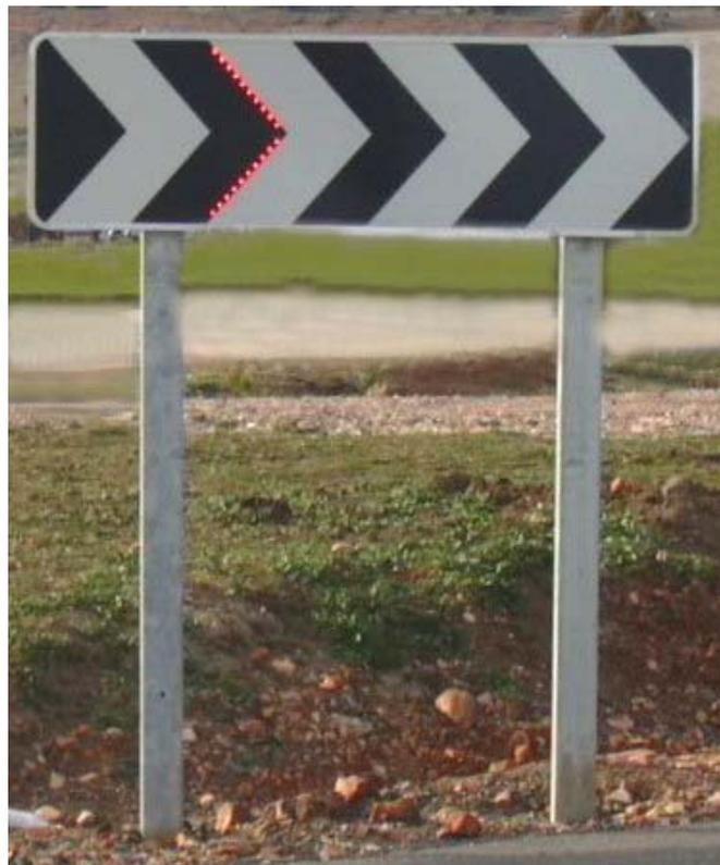
Las señales direccionales tienen un fácil acceso a su interior, que facilita la sustitución o reparación de componentes. Se utiliza un diseño de interconexión de los leds que garantiza el funcionamiento del resto en caso de fallo o avería de alguno de ellos. Evitando el efecto “caída en cascada”. Para la inserción de los leds se utilizan unas bases de caucho vulcanizado que evita la entrada de agua por el frontal.
