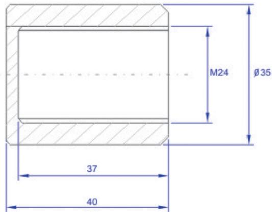
Soporte de acero o acero inoxidable para fijar sobre la estructura portante de la construcción y permitir la unión con el espárrago regulador.
