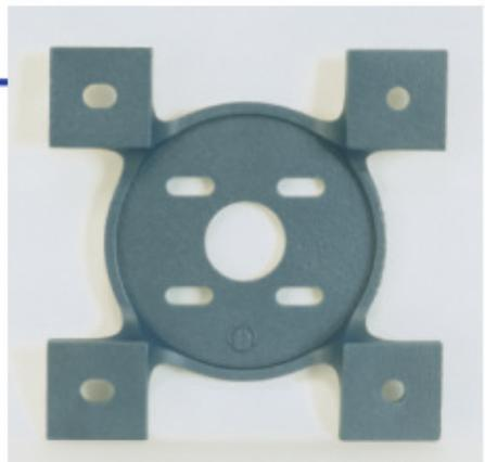
Araña RB-F de unión entre vidrios, de acero de fundición de alta resistencia GGG-50 DIN-1693 de límite elástico mínimo de 320 MPa y mecanizada en banco CNC, bicromatada y lacada al horno con epoxi color RAL.
