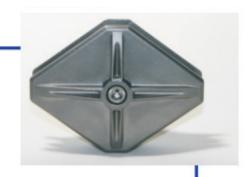
Patch-Fitting de acero inoxidable AISI 316 de unión de crucera entre dos/cuatro vidrios. De microfusión a la cera perdida de acabado superficial chorreado con granalla de inoxidable y mecanizado en banco CNC.
