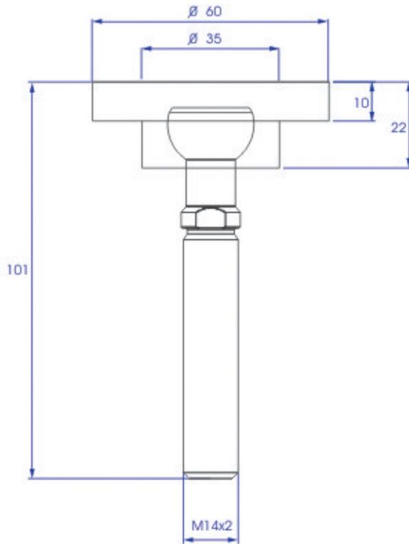
**Rótula GLUEpart de acero inoxidable AISI-316. Permite la fijación puntual en base a adhesivos estructurales evitando los taladros en el vidrio y proporcionando ventajas importantes tanto en eficiencia como en seguridad.**
