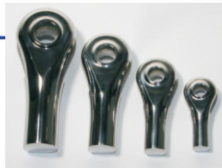
Terminal Epsilon de acero inoxidable AISI 316 de microfusión a la cera perdida de límite elástico mínimo de 210 MPa y mecanizado en banco CNC.
