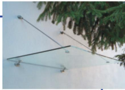
Sistema de marquesina de vidrio estructural PUNTpart, construida con vidrio laminado de seguridad, accesorios y rótulas de acero inoxidable AISI-316. Sistema estable con los componentes de vidrio rotos.
