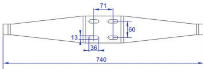
Araña RM-N de unión de crucera entre vidrios, de acero de fundición de alta resistencia GGG-50 DIN-1693 de límite elástico de 320 MPa y mecanizada en banco CNC.
