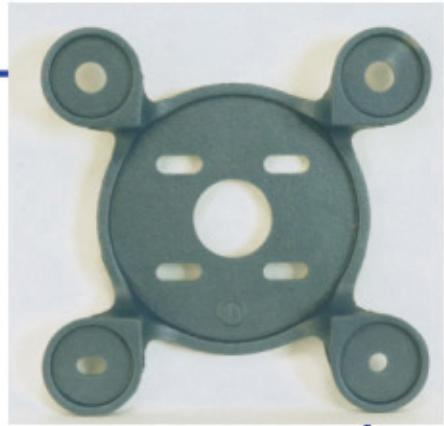
Araña RB-FR de unión entre vidrios, de acero de fundición de alta resistencia GGG-50 DIN-1693 de límite elástico mínimo de 320 MPa y mecanizada en banco CNC, bicromatada y lacada al horno con epoxi color RAL.
