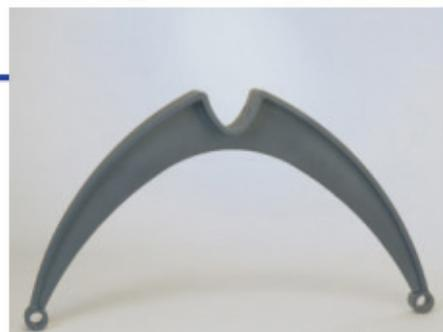
Araña CT-N de unión de crucera entre vidrios, de acero de fundición de alta resistencia GGG-50 DIN-1693 de límite elástico de 320 MPa y mecanizada en banco CNC.
